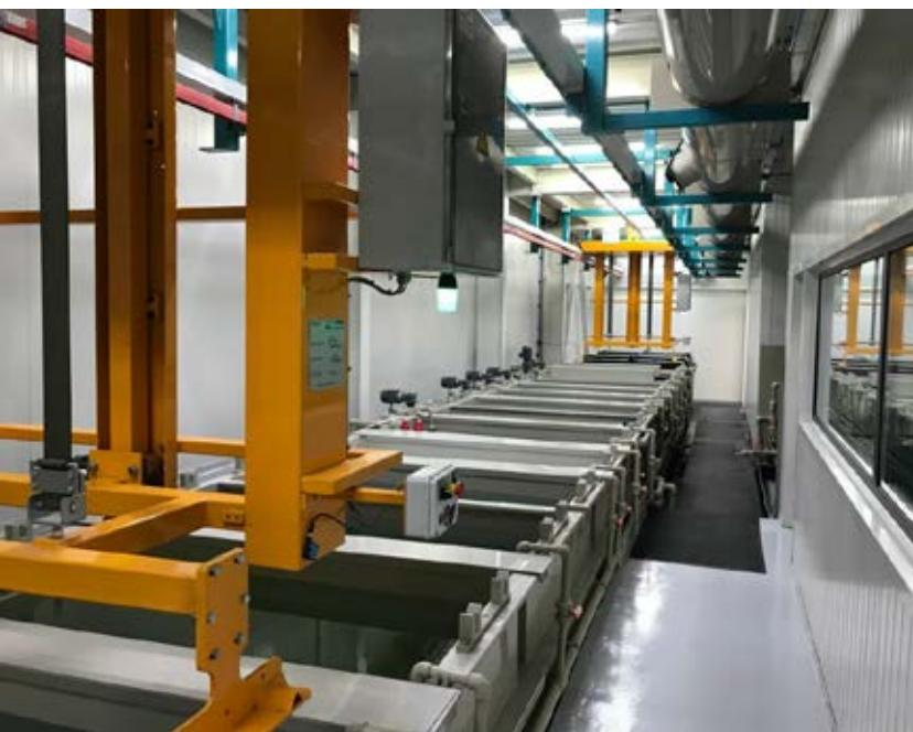
Катодно електрофорезно боядисване (катафореза - KTL), сачмоструене в турбинна камера, трикатийонно фосфатиране и прахово-полимерно боядисване в цеха за специализирани покрития на Gladiator.
